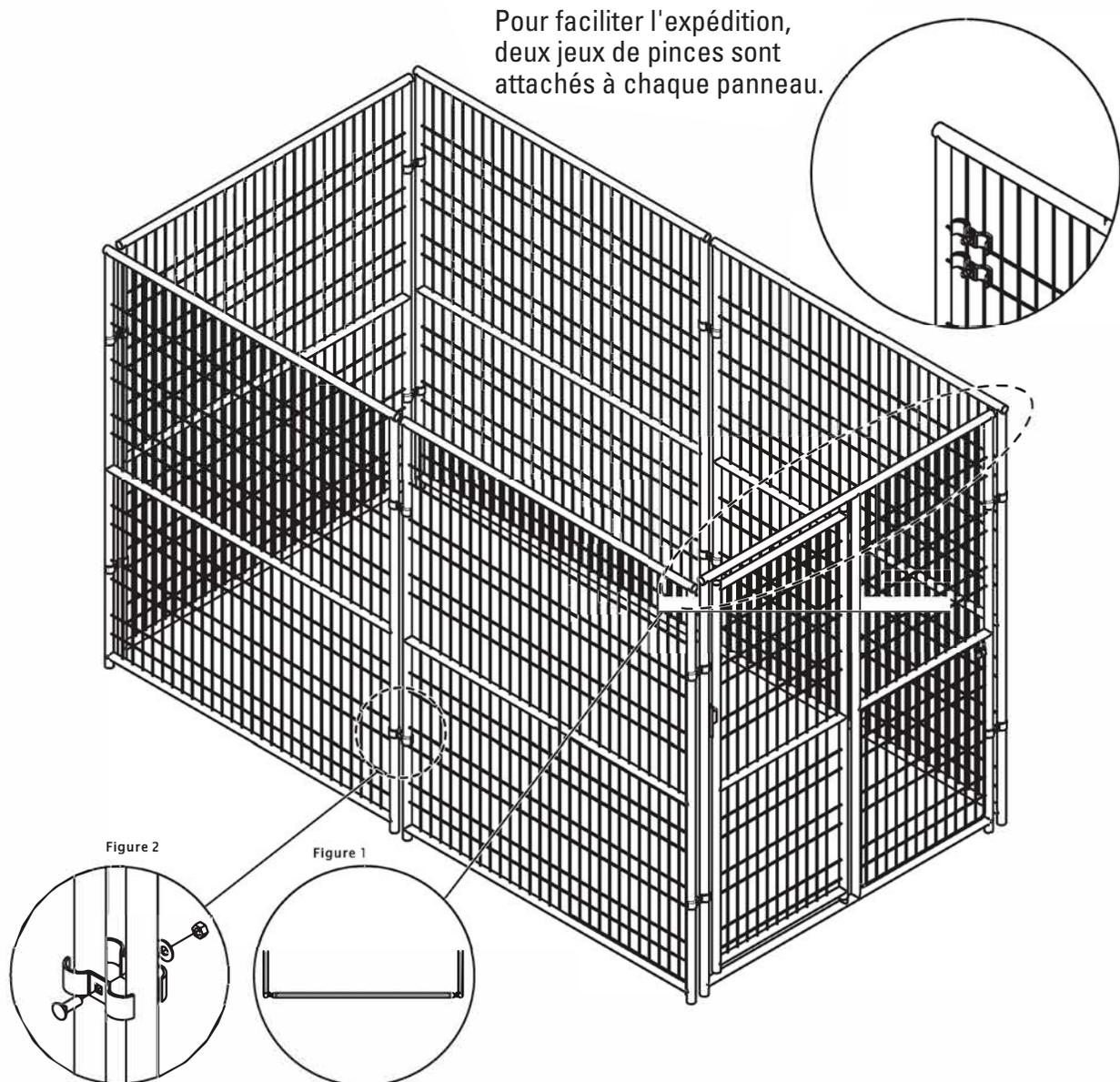
**Remarque :** Veillez à positionner les panneaux avant et arrière dans l'orientation indiquée sur la figure 1. Les panneaux avant et arrière doivent être placés à l'intérieur des panneaux latéraux.
